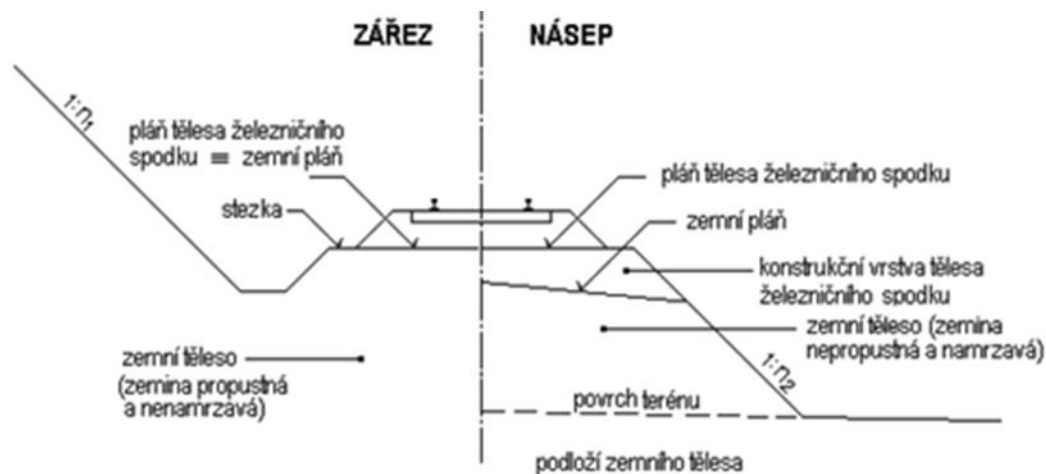
Obrázek č. 5: Hlavní části železničního spodku
