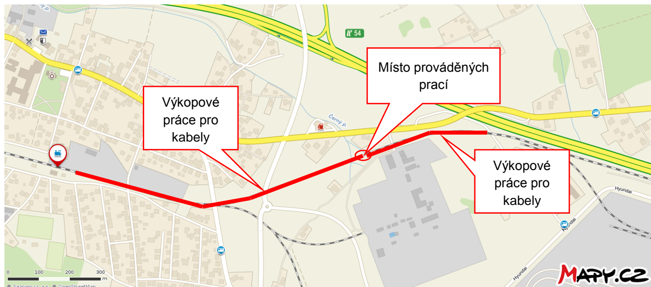
Obrázek 1: Situace rekonstrukce PZS přejezdu P8310v km 118,000 trati Frýdek Místek – Český Těšín
